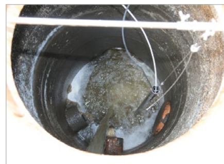
Figura 1. A introdução de um sensor de fase líquida diretamente no fluxo de águas residuais possibilita uma representação mais completa da concentração real de H 2 S nesse fluxo. Tal contrasta favoravelmente com os sensores apenas de fase gasosa que podem representar a extensão do problema de forma meramente parcial com base na distância entre a água e o sensor ou na quantidade de turbulência num poço húmido.
