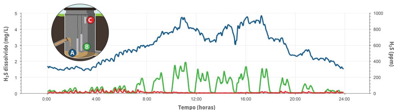
Figura 3. Este gráfico apresenta as diferenças nas leituras contínuas de um sensor de fase líquida instalado diretamente no fluxo de águas residuais (a azul) em comparação com sensores de fase gasosa instalados imediatamente acima da superfície da água (a verde) ou perto do topo de uma porta de inspeção (a vermelho). É de realçar as leituras gerais mais baixas e a queda periódica dos valores de H 2 S na linha verde, indicativas das diferenças entre a inatividade do bombeamento e os fluxos turbulentos que libertam mais H 2 S gasoso. Observe como as medidas tiradas perto do topo da porta de inspeção não refletem as incidências mais elevadas de H 2 S.
