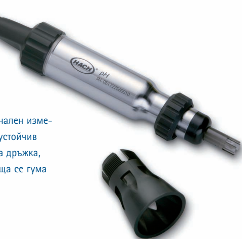
Електрод за работа на открито с издръжлив водоустойчив корпус (IP67), противоударното устройство може да се отстранява при почистване
