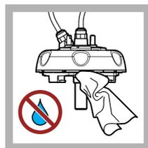
**11.** Убедитесь, что на измерительном модуле (или модуле автоматической очистки) нет воды. Устраните все разливы, чтобы предотвратить попадание воды в кюветное отделение.
