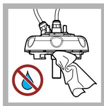
**12.** Убедитесь, что на измерительном модуле (или модуле автоматической очистки) нет воды. Устраните все разливы, чтобы предотвратить попадание воды в кюветное отделение.
