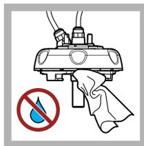
**16.** Убедитесь, что на измерительном модуле (или модуле автоматической очистки) нет воды. Устраните все разливы, чтобы предотвратить попадание воды в кюветное отделение.
