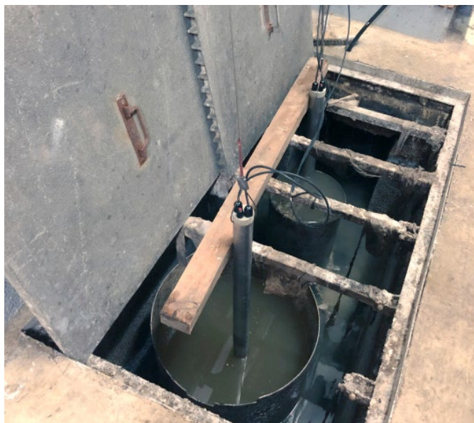
Figure 3. La possibilité de monter un capteur comptable pour des mesures en phase gazeuse ou en phase liquide, de manière permanente ou temporaire et ce, directement dans les eaux usées ou dans l'air au-dessus, offre aux opérateurs de station de traitement des eaux usées une flexibilité maximale pour quantifier les problèmes d'odeurs potentiels, les menaces pour la sécurité ou les perturbations de procédés sur l'ensemble de leur installation.
