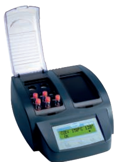
DRB200-1 na 9 kuwety (ø16 mm) oraz 2 naczynek reakcyjnych
