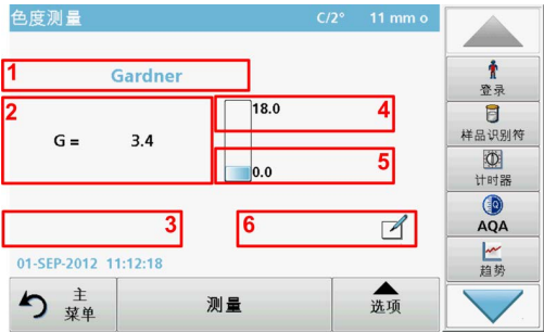
图 3 测量模式下的触摸感应区域
