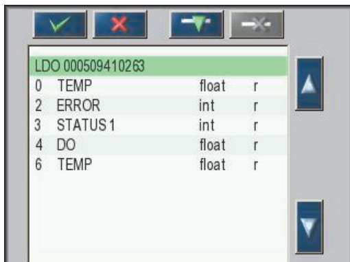
Фигура 47 Конфигурационно меню Profibus/Modbus—Списък на Telegram с нов таг
