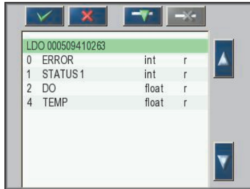
Фигура 45 Конфигурационно меню Profibus/Modbus—Device list (Списък на устройствата)
