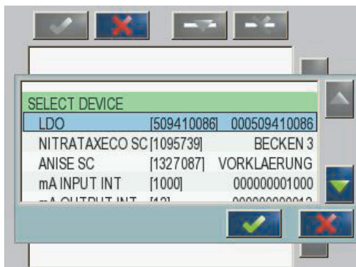
Фигура 44 Конфигурационно меню Profibus/Modbus—Select device (Избор на устройство)
