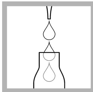
3. Pipetter soigneusement 2.0 mL d'échantillon.
