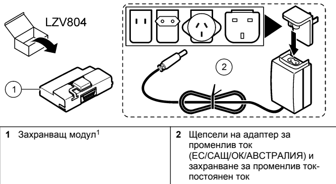
Фигура 1 Компоненти на захранващ модул
