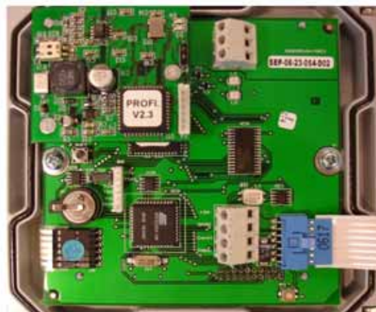
Scheda CPU con opzione PROFIBUS
