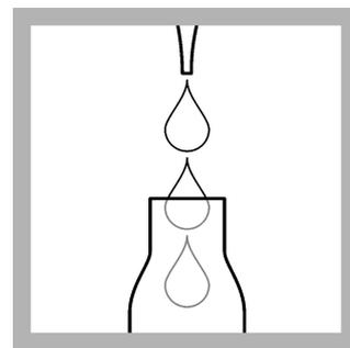
4. Pipetter soigneusement **0.3 mL d'échantillon**.
