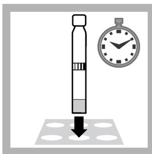
7. Placer le tube dans le réacteur **préchauffé**. Chauffer la cuve dans le réacteur pendant **2 heures**.
