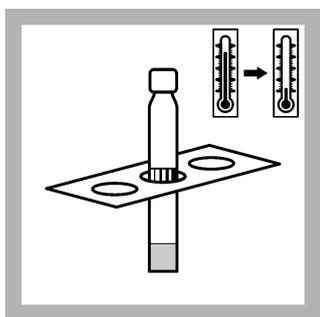
10. Placer le tube dans un support de cuve et le **laisser refroidir** à température ambiante.
