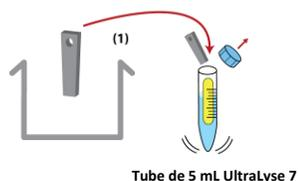
**ASTUCE :** Essayez de tester le dispositif de collecte de biofilm le plus rapidement possible après son retrait du fluide de traitement.
