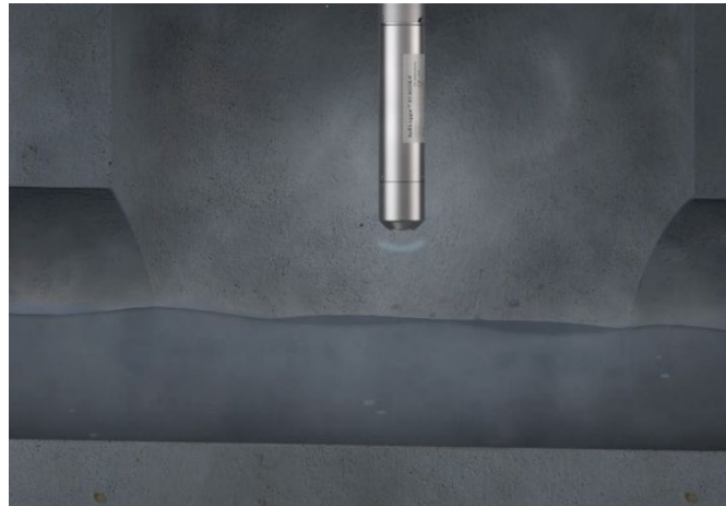
Figur 4. Möjligheten att ha en bärbar givare som är tillräckligt mångsidig för att mäta H 2 S i vätskefasen (vänster) och gasfasen (höger) ger yrkesverksamma på avloppsvattenområdet maximal flexibilitet för att identifiera problemområden, lokalisera optimala platser för kontinuerlig övervakning och optimera kemiska behandlingar i enlighet med föränderliga koncentrationer. Om det är praktiskt genomförbart ger avkänning i vätskefasen den mest exakta mätningen av verklig förekomst av vätesulfid i avloppsvattnet.
