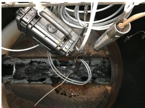
Hach H<sub>2</sub>S 传感器直接测量污水及其上方空气中的 H<sub>2</sub>S。
