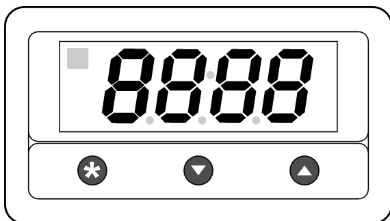
Πίνακας 2 Ελεγκτής θερμοκρασίας—Οθόνη και πλήκτρα
