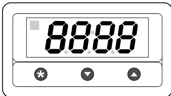
Figura 9 Controller della temperatura
