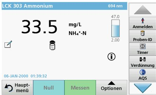
Bei einer photometrischen Analyse können Trübungen und Färbungen in der Probenmatrix zu falschen Analyseergebnissen führen. Diese störenden Faktoren stammen entweder aus der Probe selbst oder entstehen durch Reaktionen mit den Reagenzien.
