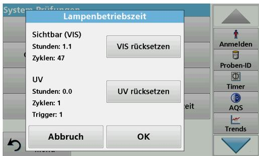
Nach einem Lampenwechsel wird im Menü „Lampenbetriebszeit“ die Anzeige der gesamten Betriebszeit auf 0 zurückgesetzt.
