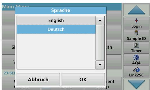
Die Software des DR 6000 unterstützt mehrere Sprachen. Wenn Sie das Gerät zum ersten Mal einschalten, öffnet sich automatisch nach dem Boot-Vorgang eine Liste zur Auswahl einer Sprache.
