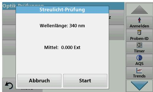
Der Mittelwert wird aus 3 aufeinander folgenden Extinktionsmessungen berechnet.
