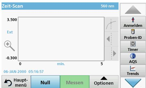
Nachdem alle Scan-Parameter ausgewählt wurden, muss zuerst eine Nullmessung durchgeführt werden. Danach kann die Probe analysiert werden.
