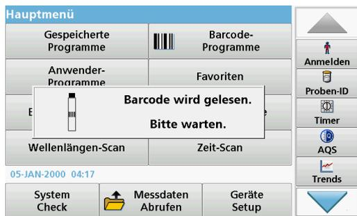
1. Bereiten Sie den Barcodetest entsprechend der Arbeitsvorschrift vor und setzen Sie die Küvette in den Küvettenfach (1) ein.
