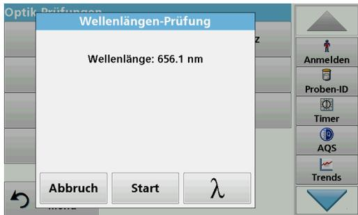
1. Tippen Sie auf **Wellenlängen-Prüfung** im Menü „Optik-Prüfungen“.
