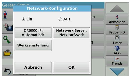
Für die Datenübertragung an einen PC oder zur Einbindung in ein Netzwerk müssen die Verbindungsparameter konfiguriert werden.
