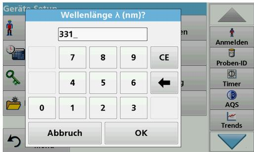
Mit UV-Schalter wird die Umschaltwellenlänge festgelegt, bis zu welcher Wellenlänge die UV-Lampe als Lichtquelle dient und ab wann die VIS-Lampe.
