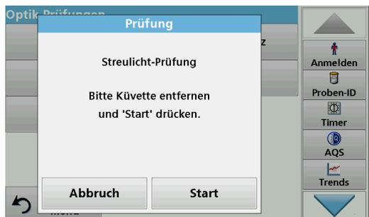
7. Entfernen Sie eventuell vorhandene Küvetten aus dem Küvetenschacht.
