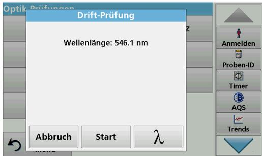
1. Tippen Sie auf **Drift-Prüfung** im Menü „Optik-Prüfungen“.
