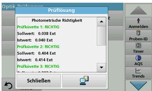
9. Nach der fünften Prüfküvette wird die Photometrische Richtigkeit in einem Protokoll angezeigt.
