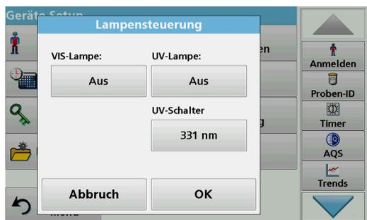
1. Tippen Sie **Lampensteuerung** im „Geräte Setup“.
