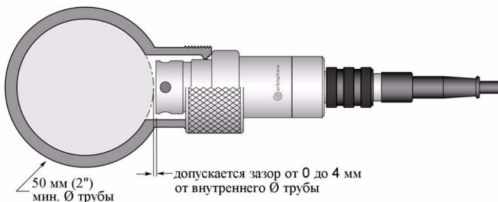
Рис. 3-1: Приварной разъем датчика
