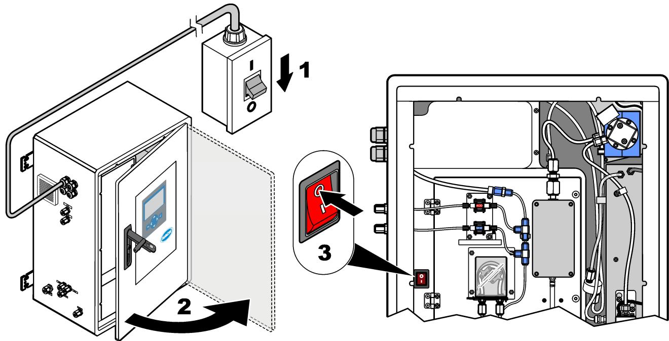
**Slika 2 Zamijenite osigurač na ploči za napajanje i ulaz/izlaz**
