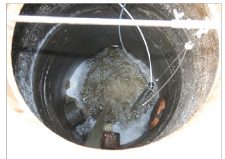
图 1.将液相传感器直接插入污水流中,可以获得该污水流中 H 2 S 真实浓度的完整表征。这与气相传感器截然不同,气相传感器存在对问题范围的表征不足的缺点,它受到水与传感器之间的距离或湿井中的湍流量的影响。
