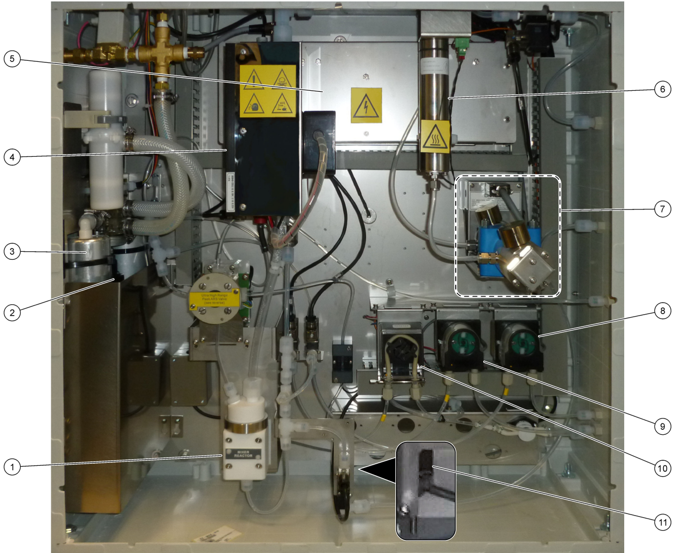
Slika 21 Analizno ohišje – črpalke in sestavni deli (pred septembrom 2022)
