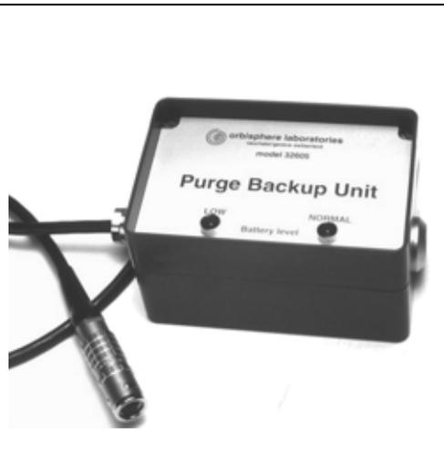
Die Reserve-Reinigungseinheit 32605 wird zwischen dem Instrument und dem Sensor angeschlossen. Die internen Batterien werden automatisch über das Sensorkabel geladen, wenn das Instrument eingeschaltet ist.
