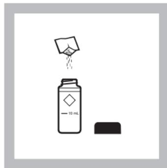
3. Transférer le contenu d'une pochette de réactif de molybdate dans la deuxième cuve.
