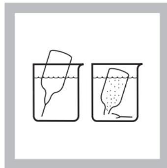
3. Remplir une ampoule AccuVac de sulfate SulfaVer 4 avec l'échantillon.
