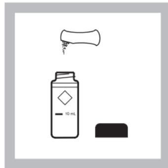
3. Transférer le contenu d'une pochette de réactif SulfaVer 4 dans la cuve (l'échantillon préparé).
