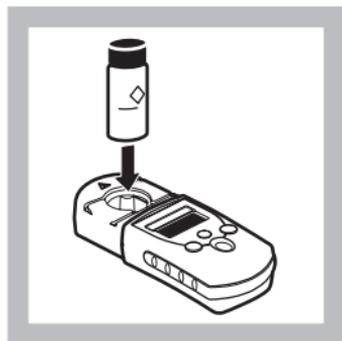
**10.** Dans les 5 minutes après la période de réaction essuyer l'extérieur de la cuve contenant l'échantillon préparé et l'introduire dans le compartiment de cuve, en dirigeant le losange vers l'avant de l'appareil.
