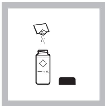
4. Transférer le contenu d'une pochette de réactif acide pour la gamme haute en silice dans la même cuve.
