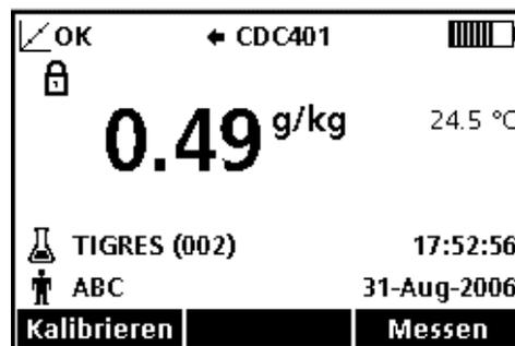
Abbildung 17 Beispiel für eine Leitfähigkeitsmessung, angezeigt in Salinitätseinheiten
