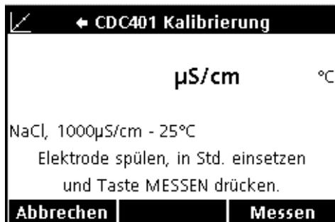
3. Die Taste **GRÜN/RECHTS** unterhalb von Messen drücken. Das Gerät berechnet die Zellkonstante nach dem gewählten Kalibrierungsstandard.
