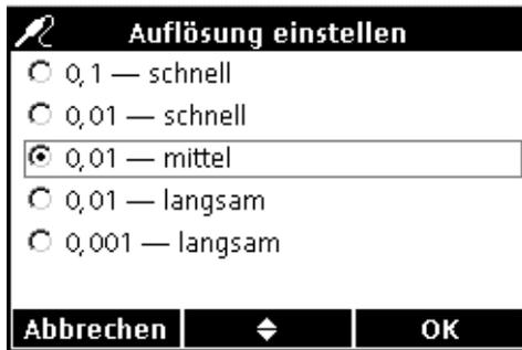
3. Mit den Pfeiltasten die gewünschte Auflösung und Ansprechgeschwindigkeit auswählen. Die genauesten Messungen werden mit der Einstellung „Langsam“ erzielt. Taste **GRÜN/RECHTS** unterhalb von OK drücken.
