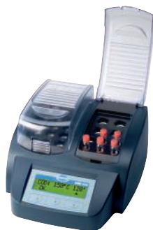
De DRB200-2 is uitgerust met twee apart van elkaar bedienbare verwarmingselementen
