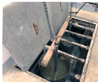
Deux capteurs H<sub>2</sub>S de Hach ont surveillé en permanence l'H<sub>2</sub>S dissous dans les eaux usées non traitées au niveau de deux entrées de la station de traitement des eaux usées de Cassis.
