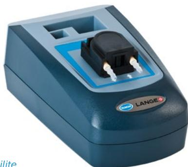
Le compartiment de cuve rectangulaire peut être facilement retiré par l'utilisateur à des fins de nettoyage.
