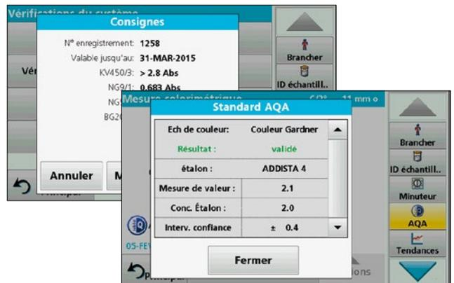
Filtres de test certifiés, solutions colorantes reproductibles standard Addista et implémentation intégrée des mesures AQA (Assurance qualité analytique) pour assurer un niveau optimal de fiabilité.
