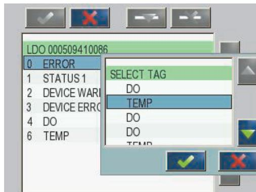
Figura 46 Menu de configuração Profibus/Modbus-Selecionar tag
