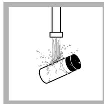
1. Limpie la parte interna y externa de las cubetas y tapas lavándolas con un detergente de laboratorio para limpieza de vidrio. Luego enjuague varias veces con agua destilada o desmineralizada.
