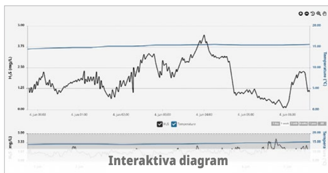
Figur 3. Alternativ för fjärråtkomst för kontinuerlig vätskefasövervakning kan förse operatörer med detaljerad insyn minut för minut i mycket exakt H 2 S-status enligt tid och temperatur, inklusive färgkodade kontrollpanelvyer för enkel identifiering av problematiska känsliga punkter som utvecklas.
