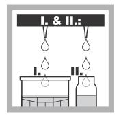
1. Préparation de la cuve zero: Remplir cuve ronde ou une cuve rectangulaire de 50 mm avec l'échantillon.
