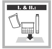
**8.** Nettoyer bien l'extérieur de la **cuve zero** et insérer la cuve dans le compartiment pour cuves.
