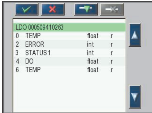
Kuva 47 Profibus//Modbus-konfigurointivalikko—Luettelo ja uusi tagi
