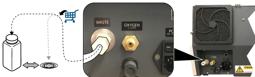
Figura 6 Conecte a tubulação de resíduos
