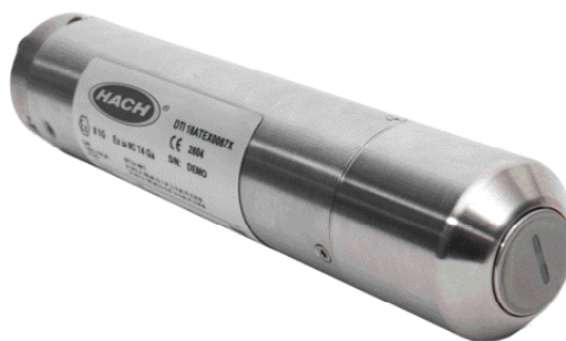
Figura 1. Questo sensore elettrochimico compatto, con un design anti-incrostazione per consentirne l'immersione nelle acque reflue, è in grado di fornire il profilo più accurato della concentrazione effettiva di acido solfidrico in fase liquida in molti punti delle reti di raccolta e degli impianti di trattamento delle acque reflue. Il vantaggio di questo monitoraggio continuo è la possibilità di utilizzare un ciclo di feedback per ottimizzare il dosaggio delle sostanze chimiche con un impegno minimo da parte del team operativo.
