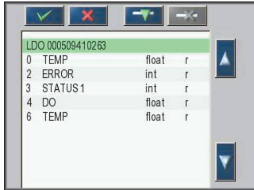
그림 47 Profibus/Modbus 구성 메뉴 — 새 태그가 있는 텔레그램 목록
