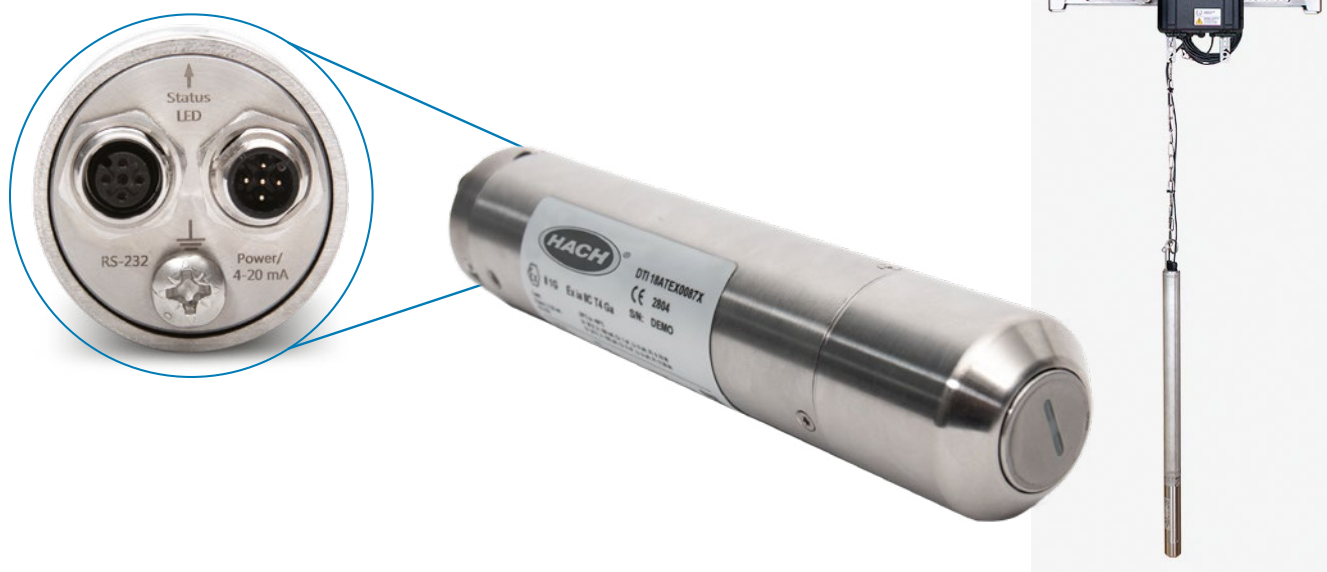
Afbeelding 2. Deze compacte, onderhoudsarme, elektrochemische sensor – met roestvaststalen behuizing, een ontwerp dat vervuiling tegengaat en industriestandaard afgedichte aansluitingen (weergegeven in callout) – biedt robuuste prestaties voor applicaties met onderdompeling in afvalwater en in de gasfase. Het instrument biedt een nauwkeurigheid van \pm 5 procent met een detectielimiet van 1 procent van het volledige bereik. Dezelfde sensor kan rapporteren in milligram per liter (mg/L) voor vloeistofmetingen en deeltjes per miljoen (ppm) voor gas-/luchtmetingen. Standaard beugelconstructies (inzet) bieden snelle en eenvoudige montage op typische mangatlocaties.
