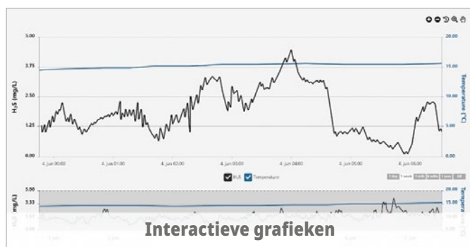
Afbeelding 3. Opties voor toegang op afstand voor continue vloeistoffasebewaking kunnen operators per minuut inzicht bieden in de uiterst nauwkeurige H_2S -toestand op basis van tijd en temperatuur. Dit omvat ook kleurgecodeerde dashboardweergaven voor eenvoudige identificatie van opkomende probleemhotspots.
