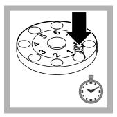
3. Colocar la cubeta de digestión, abierta, en el agitador TOC-X5, presionando hasta el tope. Poner la tapa del ventilador sobre la cubeta. Encendido del instrumento. Al cabo de 5 minutos
