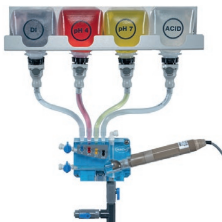
Supporto per sensore di pH Clean & CAL configurato con una sonda Hach
