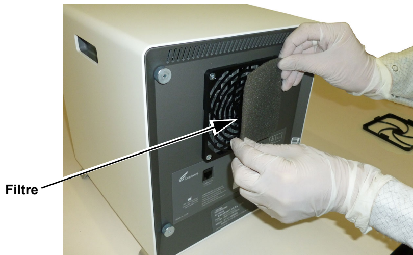
Figure 9-10. Retrait de filtre GeneXpert GX-IV
