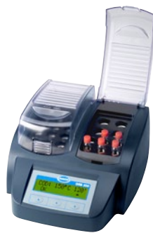
DRB200-2 este împărțit în două blocuri de încălzire controlabile separat
