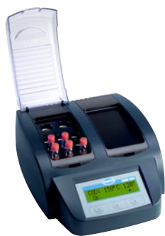
DRB200-1 pentru 9 cuvete (16 mm ø) și 2 vase de reacție
