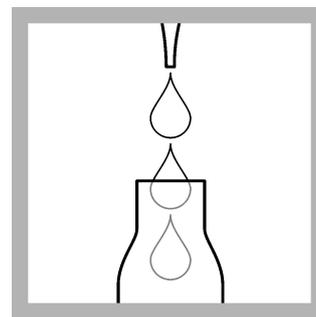
4. Pipetter soigneusement **2.0 mL d'échantillon**.
