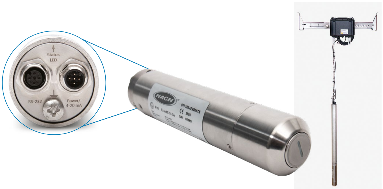
그림 2. 스테인리스-스틸 하우징의 오염 방지 설계 및 산업 표준의 연결(설명선 참조)을 지원하는 이 컴팩트하고, 유지보수가 적게 필요하며, 전기화학식 센서는 가스 상태의 적용 분야는 물론 폐수 내에서 견고한 성능을 제공합니다. 전체 범위의 1%의 검출 한계와 \pm 5\% 의 정확도를 자랑합니다. 동일한 센서로 액체 측정 시 리터 당 밀리그램 (mg/L)과 가스/대기 측정 시 백만분의 일(ppm)로 보고할 수 있습니다. 기본 브라켓 부품 (그림 참조)는 일반적인 맨홀 위치에 빠르고 편리하게 설치할 수 있습니다.
