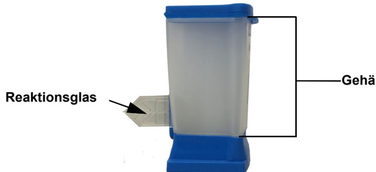
Abbildung 5-22. Kartusche mit Gehäuse und Reaktionsglas
