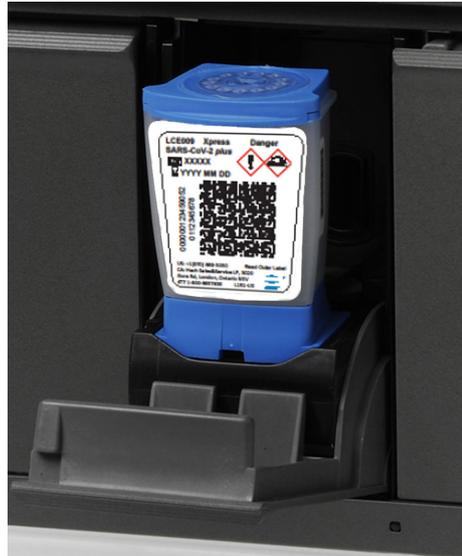
**Abbildung 5-24. GeneXpert Kartusche hinten unten im Modulfach**
