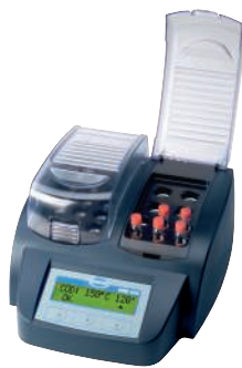
Der DRB200-2 verfügt über zwei, unabhängig voneinander steuerbare Heizblöcke
