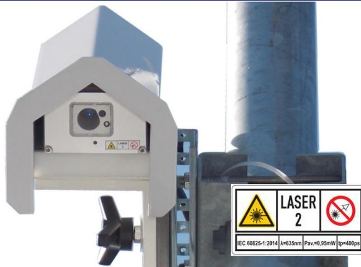
**Der Laser-basierte opto-elektronische Schneehöhensensor Lufft SHM31 bestimmt Schneehöhen millimetergenau über weite Entfernungen hinweg, ist wetterunabhängig und wartungsfrei**
